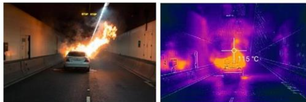
Figura 4: Incendio inicial. En el hastial del túnel se observa una temperatura de 115°C
